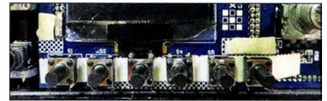
Schritt 2: Die Taster mit doppelseitigem Klebeband befestigen und die Drähte anlöten.
