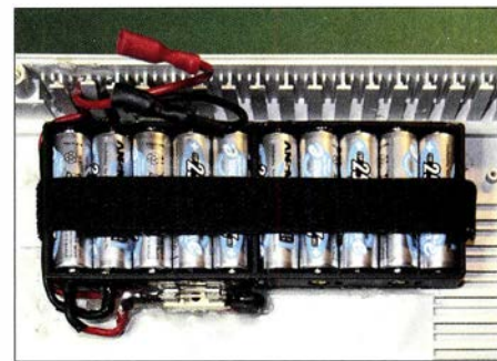
Bild 6: Der Batteriehalter für zehn NiMH-Akkumulatoren ist samt Sicherung im Gehäusesedendeckel verklebt. Ein durch Schlitze im Halter geführtes Klettband verhindert das Herausfallen der Akkumulatoren.
