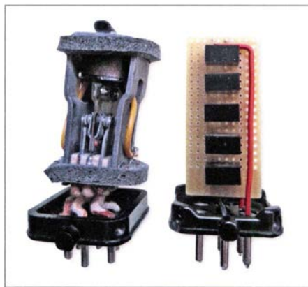
Bild 2: Elektromechanischer Zerhacker und moderne Ersatzbaugruppe
