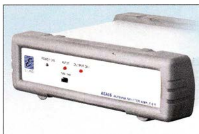
Frontseite des ASA-16 mit den drei Status-LEDs und dem Umschalter des Abschwächers
