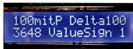
Bild 3: LC-Display der Arduino-Aufsteckplatine mit Eingabe- und Steuerwerten
